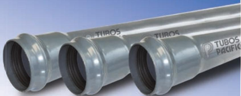
El sistema Rieber es un sistema de junta o sello elastomérico totalmente "integrado" al tubo, el sello elastomérico tiene un interior metálico que es el que mantiene firme a la junta en su posición tanto con presión positiva como negativa.
